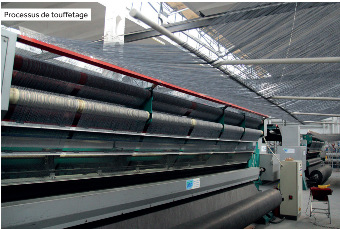
Bobinage des poils tuftés
